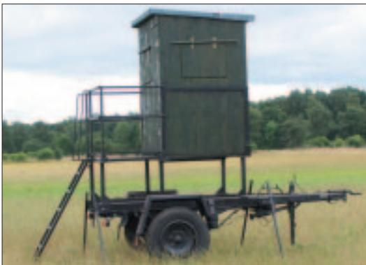
Dieser mobile Hochsitz besitzt eine Betriebserlaubnis für die Teilnahme am öffentlichen Straßenverkehr. Beim Jagdeinsatz ist die Standsicherheit durch die ausgezogenen Stützen gegeben. Die klappbare Leiter mit rutschsicheren Sprossen gewährleistet einen sicheren Aufstieg.
