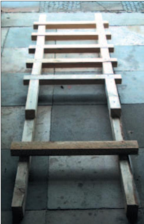
5. Die unterste Sprosse (Nr. 7) mit je zwei Nägeln pro Holm aufnageln. Der Sprossenüberstand beträgt 5 cm auf jeder Holmseite. Damit die Holme beim Zusammenbau parallel liegen bleiben, wird nach der ersten Sprosse die "sechste Sprosse" ca. 50 cm unterhalb der oberen Holmenden aufgenagelt. Dann die Distanzhölzer und Sprossen im Wechsel befestigen.
